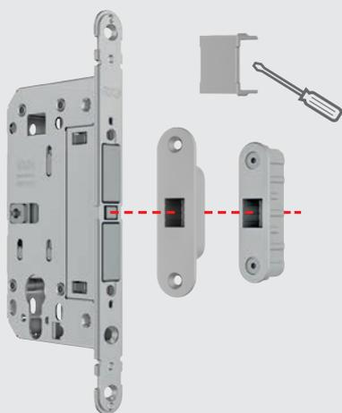
Allineamento di **Touch & Close** con gli incontri **Easy-Touch** e **Alu-Touch**. È necessario rimuovere il tappino dall'incontro per permettere l'alloggiamento del catenaccio in posizione di chiusura.
